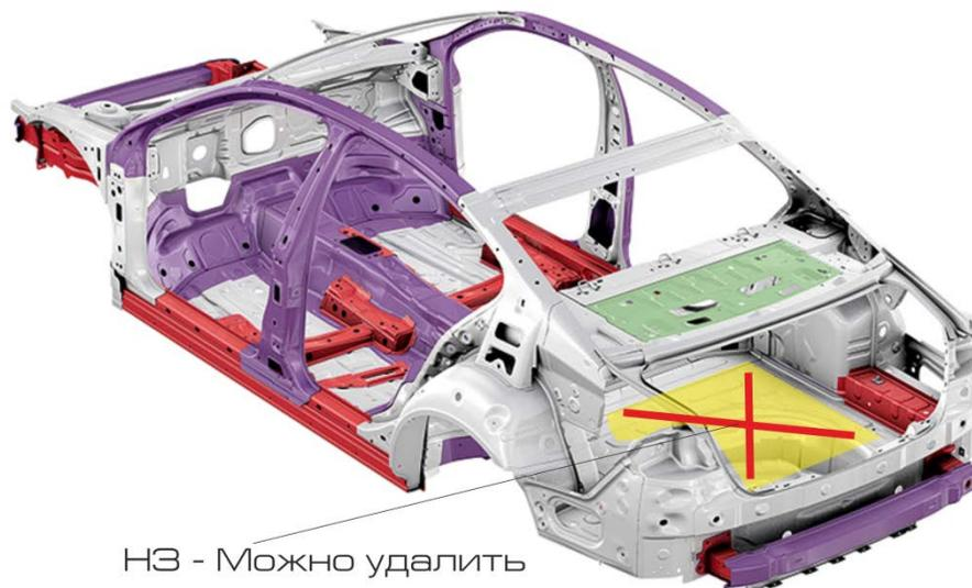
Рис. 4. Общая схема силовой структуры кузова.
