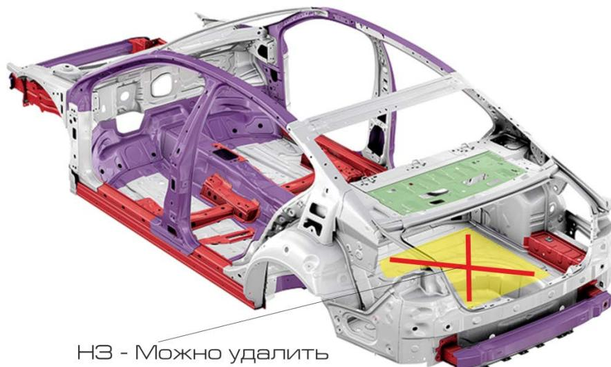
Рис. 4. Общая схема силовой структуры кузова.
